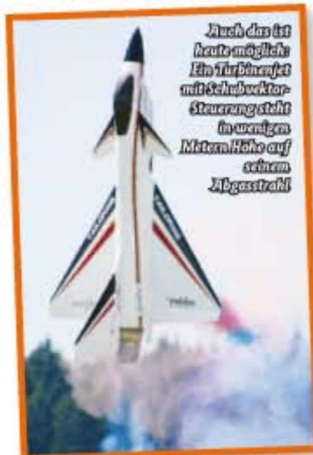
Auch das ist heute möglich: Ein Turbinenjet mit Schubvektorsteuerung steht in wenigen Metern Höhe auf seinem Abgasstrahl
