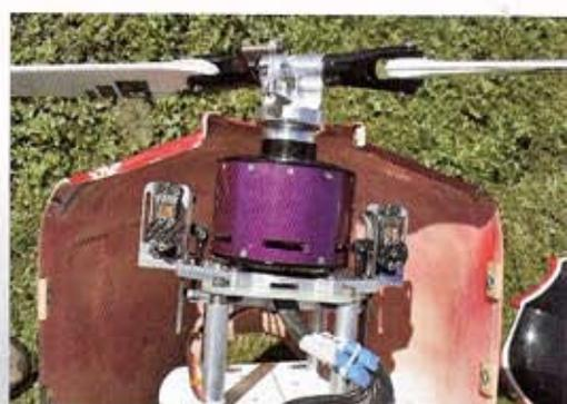
Der Motor ist ein modifizierter Hacker 200/8, Welle und Propellernabe sind Eigenanfertigungen. Verstellt wird der 85-cm-Prop von zwei 32-kg-Servos von Savox.
