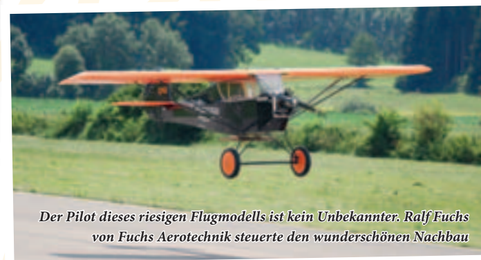
Auf den ersten Blick ist diese Maschine nichts Besonderes. Doch Markus Rummer steuert hier das erste 4D-Großmodell überhaupt. Ausgestattet mit dem Rotorkopf eines Helis als Verstellpropeller kann das Modell sogar kurze Zeit rückwärts fliegen
