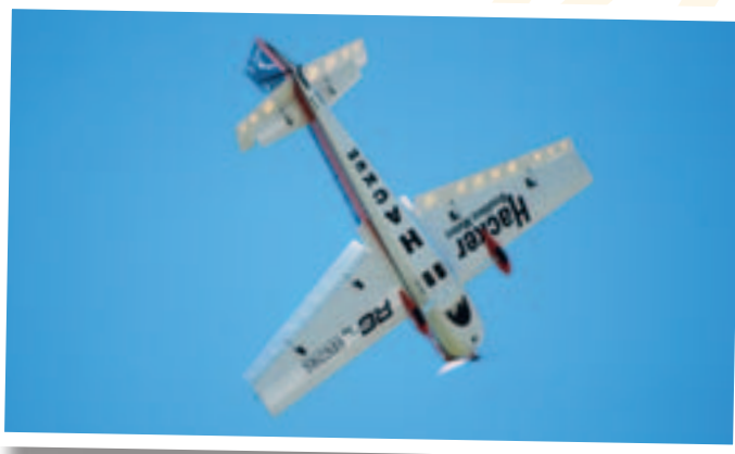
Auf den ersten Blick ist diese Maschine nichts Besonderes. Doch Markus Rummer steuert hier das erste 4D-Großmodell überhaupt. Ausgestattet mit dem Rotorkopf eines Helis als Verstellpropeller kann das Modell sogar kurze Zeit rückwärts fliegen
