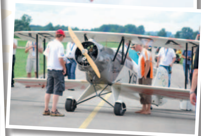
Die Bücker Jungmeister von Helmut Müller war an diesem Wochenende eindeutig das größte Modell. Abfluggewicht: 130 Kilogramm, Spannweite: über 5 Meter, Leistung: 50 PS
